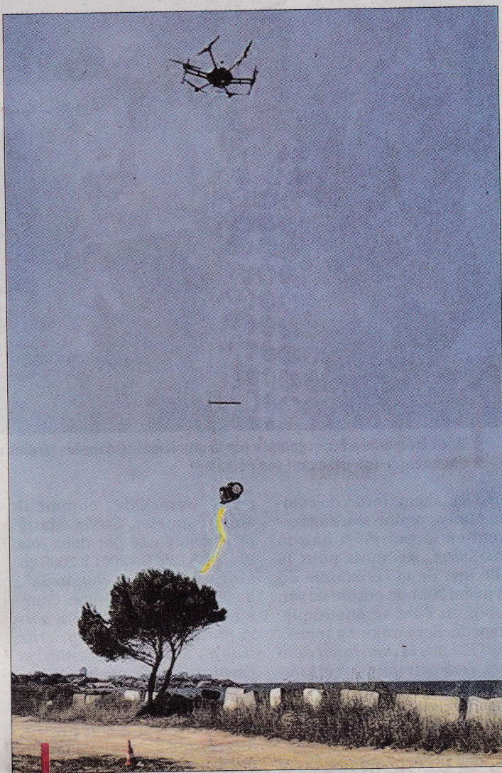
Le drone équipé d'un engin capteur de fumées, va permettre à l'association d'analyser les particules émises des industries. / DR
